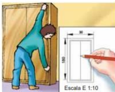
Dibujo a escala 1:10. Significa que una unidad en el plano equivale a 10 unidades en la realidad ( e < 1 ).
