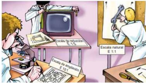
Cuando se representa un objeto a escala todas sus dimensiones se varían en la misma proporción con objeto de lograr el tamaño deseado en el dibujo.
