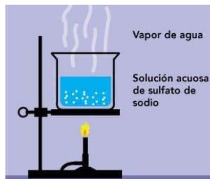
**Evaporación:** El procedimiento de evaporación consiste en separar los componentes más volátiles exponiendo una gran superficie de la mezcla. El aplicar calor y una corriente de aire seco acelera el proceso. Puede efectuarse mediante presión reducida de tal forma de bajar el punto de ebullición por ejemplo del solvente que se quiere separar de un extracto, en este caso se utilizan evaporadores rotatorios y permite reciclar el solvente.
