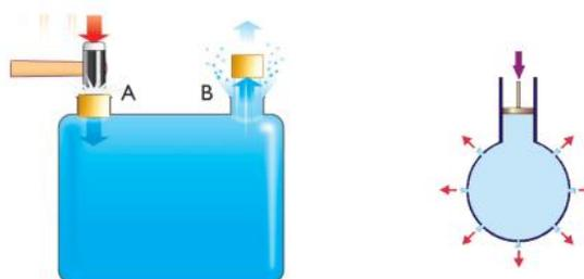
Dentro de las aplicaciones más importantes de este principio tenemos la utilización de la incompresibilidad de un líquido para transmitir una fuerza desde un punto a otro, como en una prensa hidráulica, en un sistema de frenos hidráulicos, una dirección asistida, etc...
